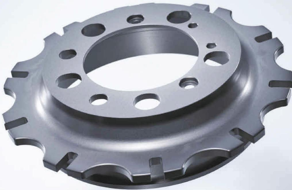
*Hybridgeschmiedeter Bremscheibentopf aus Aluminium und Eisen: 50 % weniger Gewicht als die Edelstahl-Lösung, bei gleicher Stabilität. Bilder: Leiber*
