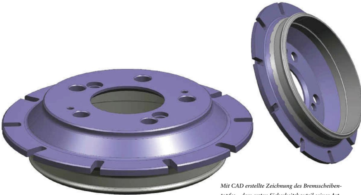
Mit CAD erstellte Zeichnung des Brems Scheibentopfes – dem ersten Sicherheitsbauteil seiner Art.
